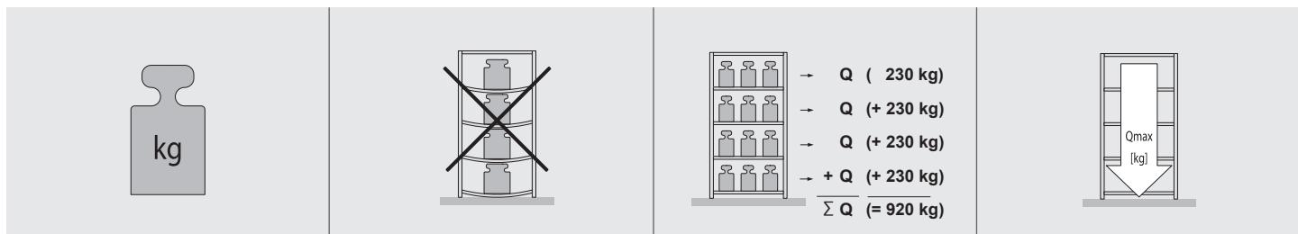
**D** Die angegebenen maximalen Tragfähigkeiten für Fachböden [Q] gelten bei jeweils gleichmäßig verteilter Last. Die Summe der Fachlasten [ $\Sigma Q$ ] in einem Regalfeld muss kleiner gleich der unten angegebenen Feldlast [Qmax.] sein. Bei Aufstellung von weniger als 3 Regalfeldern reduziert sich die jeweils angegebene Feldlast um 10%. Der Gesamtenschwerpunkt darf in jedem Fall nicht über der halben Regalhöhe liegen.
