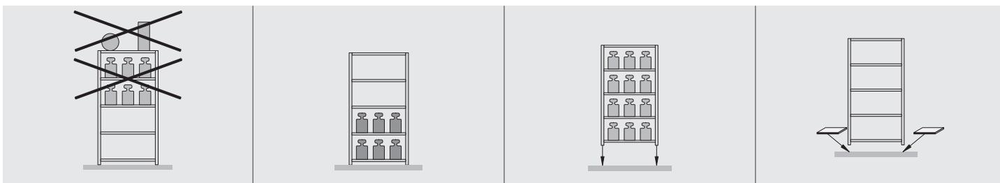
**D** Deckböden ohne seitliche Absturzsicherung sind ungeeignet zur Lagergutablage. Bei unterschiedlichen Fachlasten sollten die höheren Lasten im unteren Bereich des Regals konzentriert werden. Der Betreiber muss gewährleisten, dass der Fußboden die Lasten aus dem Stützrahmen sicher aufnehmen kann. Die Fußbodenbeschaffenheit muss den Forderungen der DIN 18202 Pkt. 4, Tab. 3, Zeile 3 entsprechen. Ist der Fußboden magnesitgebunden, müssen Kunststoffplatten unterlegt werden.
